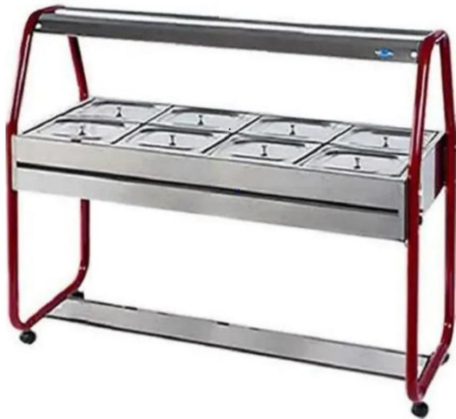
**IMPORTANTE:** A resistência sempre deverá ficar encoberta pela água. Caso contrário ela queimarará. Com o funcionamento do equipamento, a água irá evaporar lentamente. Por isso, verifique o nível de água e complete sempre que necessário.
